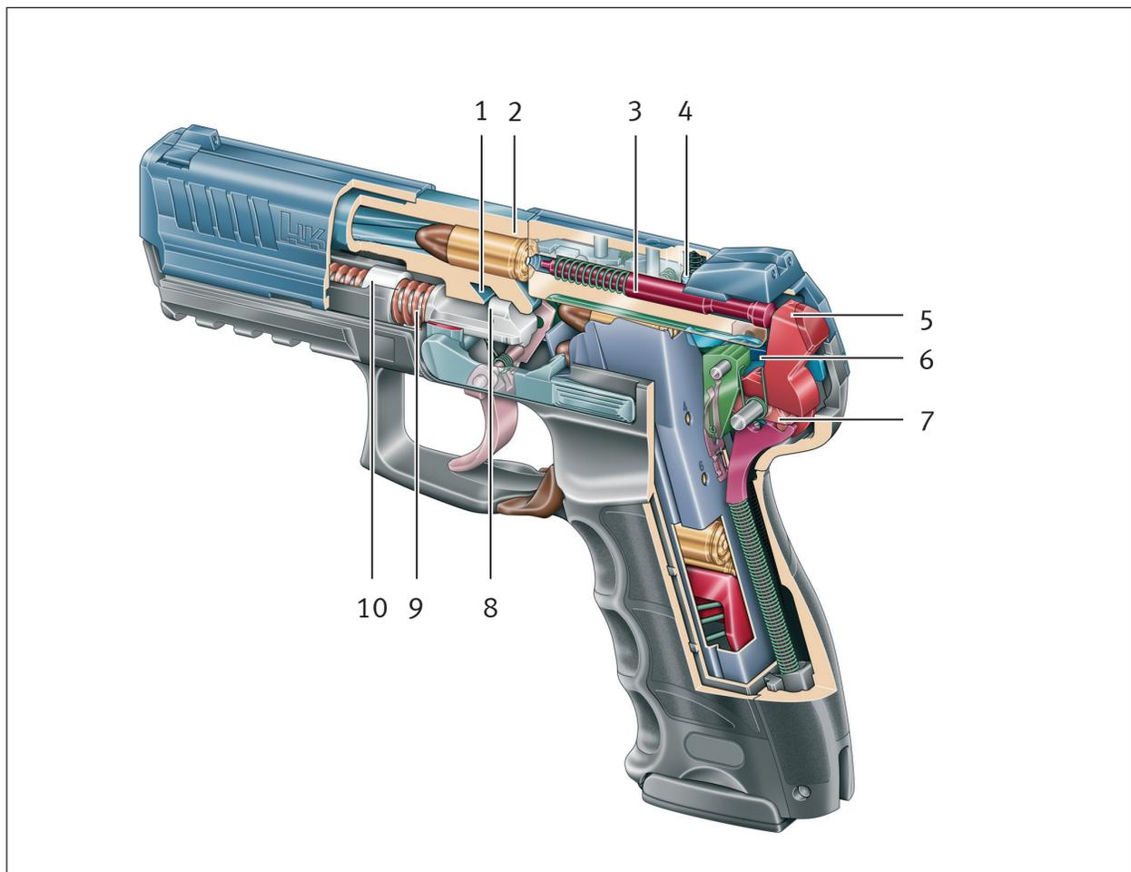
Abb. 13a: Abzugsvariante CDA, Schnittdarstellung
