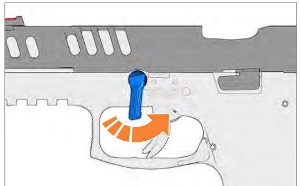
Abb. 68: Demontagehebel gegen den Uhrzeigersinn drehen
