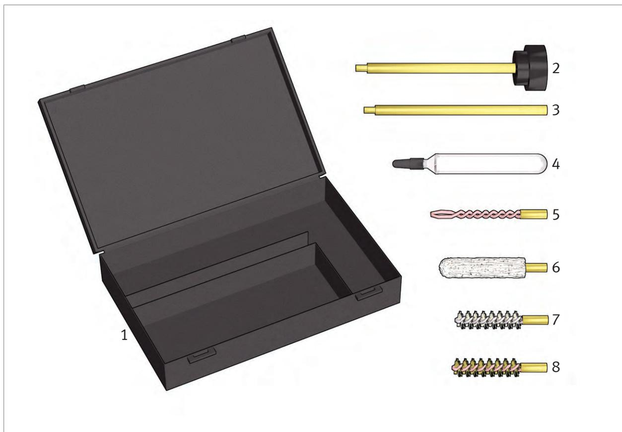
Abb. 14: Reinigungsgerät (Ident.-Nr. 988426)
