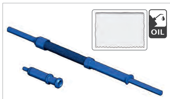
Abb. 111: Teile des Gasantriebs reinigen
