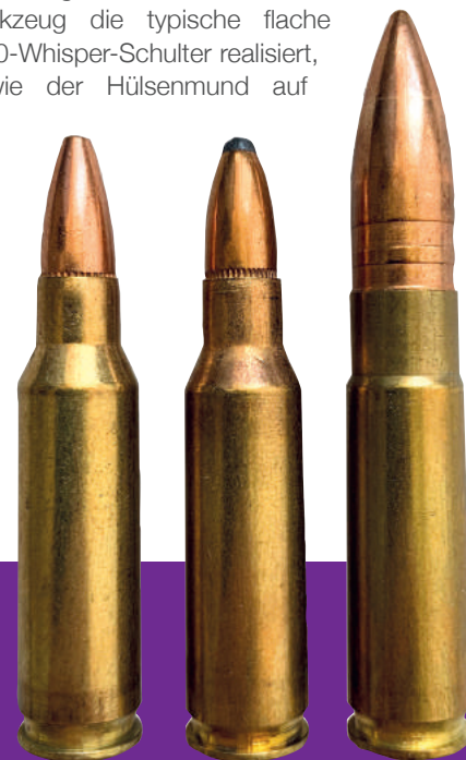
Abb. 1: Ursprünglich wurde die .300BLK (rechts) aus der umgeformten Hülse des Kalibers .221 Remington Fireball (links und Mitte) hergestellt 4 – daher stammt ursprünglich auch die Hülsenlänge der .300BLK/Whisper von 35 mm.
