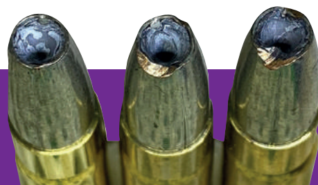
Abb. 8: Ein anderer, rein behördlicher .300BLK-Munitionstyp erzeugt permanente Zuführstörungen wie die Scharten am jeweiligen Rand der sehr großen Hohlspitze des mittleren und rechten Projektils erkennen lassen – links zum Vergleich das Geschoss einer fabrikneuen Patrone.
