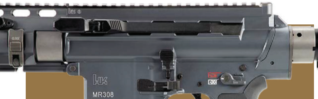
Abb. 3: Der seitliche Durchladehebel der A6-Version in vorderer Position
