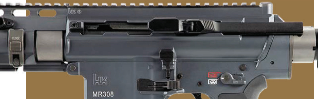
Abb. 4: Der seitliche Durchladehebel der A6-Version in maximaler hinterer Position. Diese Ansicht veranschaulicht den geringen Austrittsweg, der mit der Führungsleiste beim Durchladen zurückgelegt werden muss, so dass der liegende Schütze sich kaum bewegen oder gar aus dem Anschlag gehen muss.
