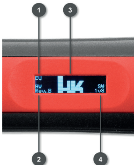
Abb. 10: Display-Anzeige des Multipen – der „Begrüßungsbildschirm“; nach dem Einschalten werden angezeigt: Regionskennung (1), Hardwareversion des Multipen (2), das Heckler & Koch-Logo (3), sowie die aktuell installierte Software-Version (4). Der Wechsel der Bildschirmansichten erfolgt per Tastendruck am Multipen.
