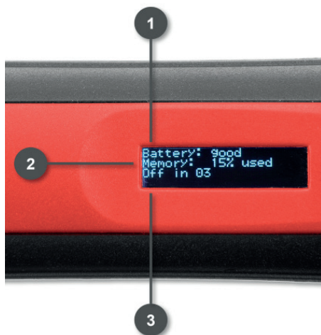
Abb. 13: Ebenfalls abrufbar sind der Ladezustand des Akkus (1), sowie die Belegung des internen Multipen-Speichers in % (2) und die Restlaufzeit bis zur automatischen Abschaltung des Multipen zwecks Stromersparnis (3).
