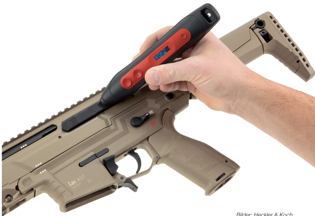
Abb. 15: Der Auslesevorgang vom waffenseitigen BMS auf das Auslesegerät Multipen erfolgt drahtlos. Der Multipen wird hierzu einfach eingeschaltet und anschließend mit seiner Spitze mit oder ohne physischen Kontakt in die Mulde des BMS positioniert. Die haptische Bestätigung des erfolgreichen Auslesevorgangs am Multipen erfolgt durch Vibration ähnlich der eines Smartphones. Rechts neben dem Display des Multipens ist der Ein-/Aus-Schalter zu erkennen, links die Menü-/Ansichtsauswahl, sowie ganz links außen die Auslesetaste, welche während des Vorgangs gedrückt gehalten werden muss bis die Vibrationsbestätigung erfolgt ist - hierdurch wird ein unbeabsichtigtes Auslesen, quasi „im Vorbeigehen“ verhindert.
