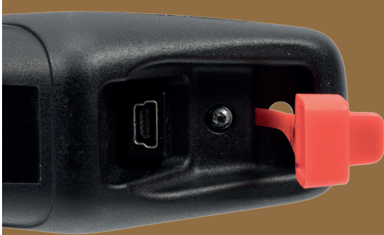
Abb. 16: Nach dem Auslesen des Waffen-BMS wird der Multipen per USB-Kabel mit einem Laptop verbunden; die Datenübertragung von Multipen zu Laptop erfolgt ausschließlich kabelgebunden.
